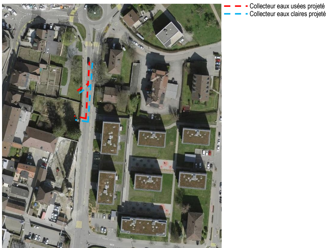
Figure 7: Emplacement approximatif des canalisations
