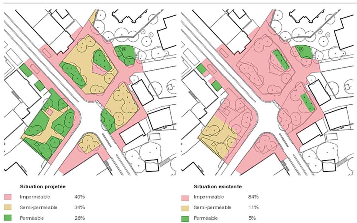
Répartition des surfaces imperméables
