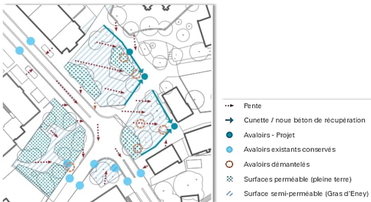
Principe d'évacuation des eaux
