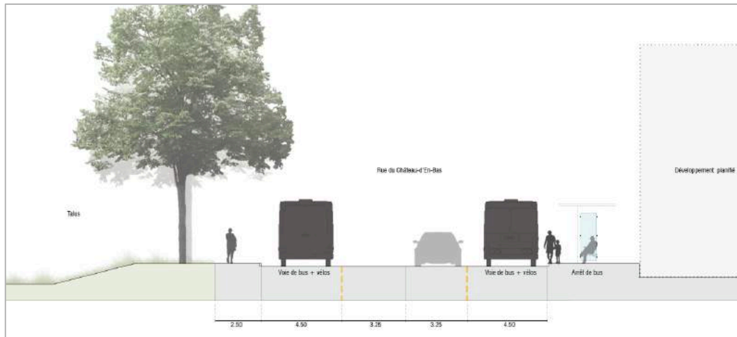
Profil de l'aménagement proposé sur la séquence 4 (source : Citec)
