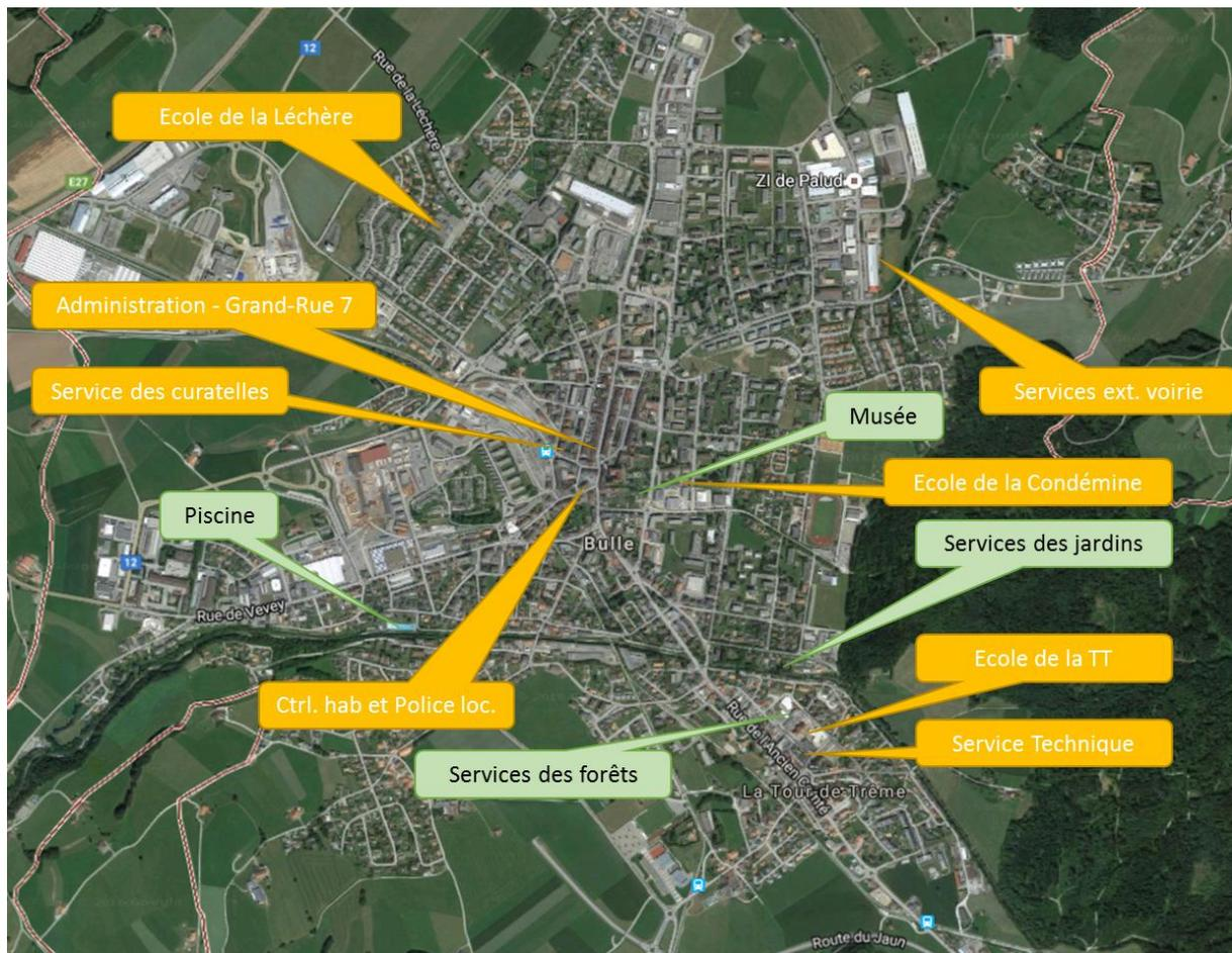
*En jaune, les sites faisant partie de la boucle fibre ou connectée en direct par fibre et, en vert, les sites indépendants ne se situant pas directement sur la boucle fibre.*
